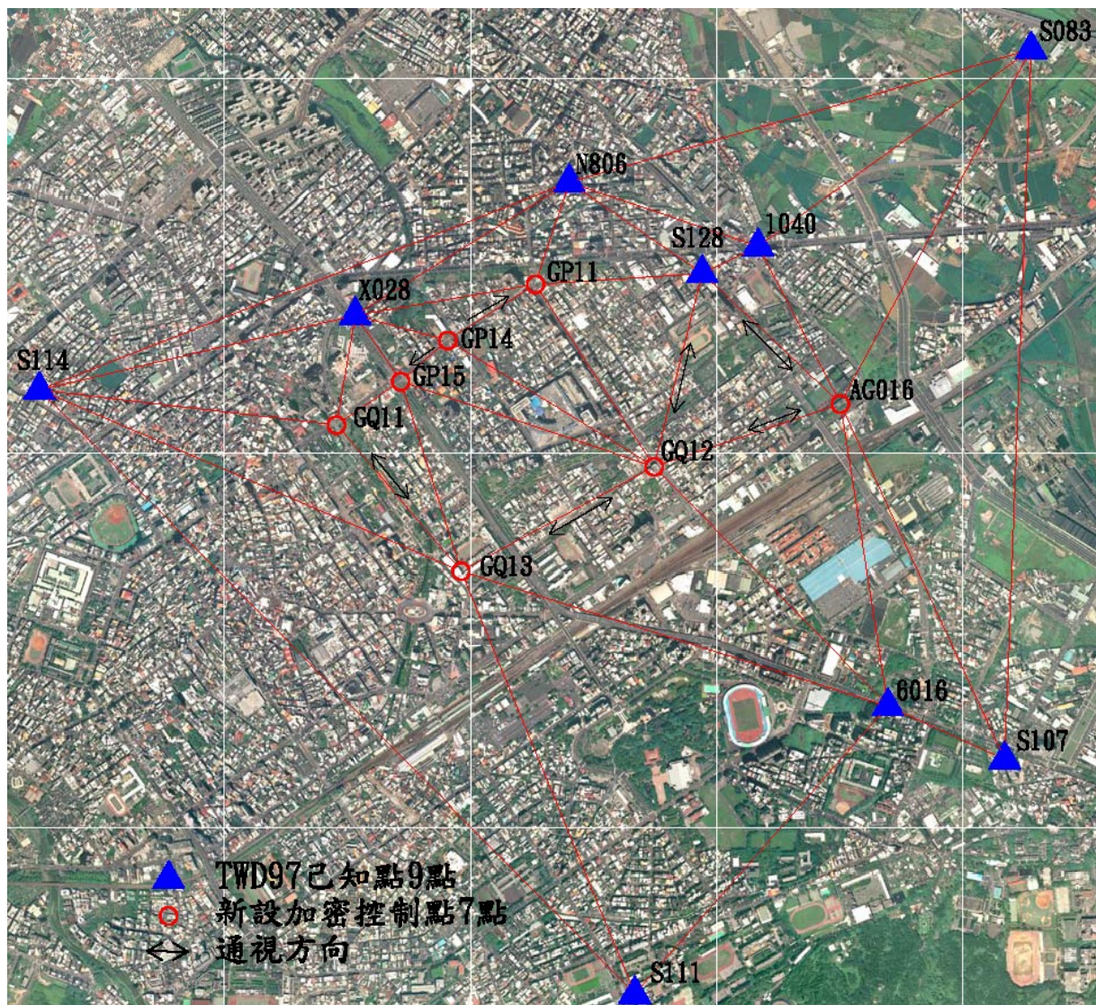
圖 3-1 新竹市 95 年度圖解數化地籍圖整合建置加密控制測量網形規劃圖
